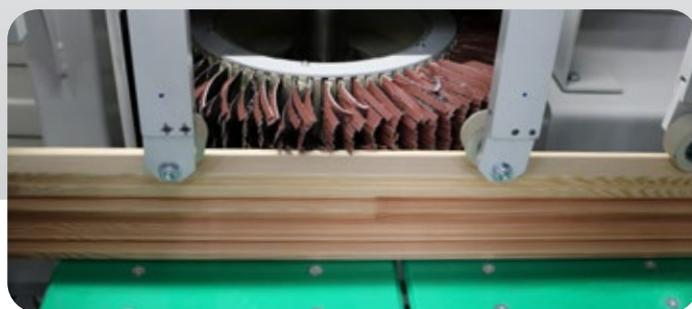
Positionnement transversal automatique des agrégats pour s'adapter avec les différentes largeurs des pièces. Mouvements effectués sur des guides linéaires.
